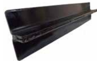
DOBLE ANGULO SOLDADO 6,0MMX- 65X65MMX6MTS (CORDONES DE SOLDADURA DE 10CM CADA 15 CM )
