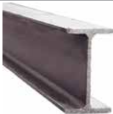
VIGA IPE420 (420X200) ACERO A36 (ALMA: 420,7X10MM - ALA 199X12MM) X 12 MTS
