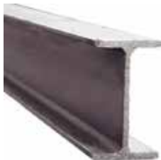
VIGA IPE220 (220X110) ACERO A36 (ALMA 223MMX- 6MM - ALA 108X9,22MM) X 12 MTS
