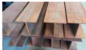
VIGAS H260 (ALMA: 260X8MM - ALA 240X10MM) ACERO A36 X 8 MTS
