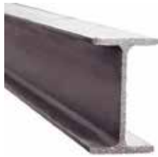
VIGA IPE140 (145X91) ACERO A36 (ALMA: 145X4,3MM - ALA 91X6,7MM) X 12 MTS
