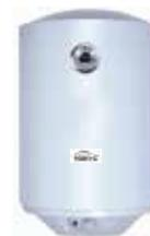
**ISONIC: TANQUE CALENTADOR DE AGUA DE 50 LITROS COLOR BLANCO** ALTURA 655 MM Y ANCHO 410 MM (1500W, 110V, 60HZ, PRESIÓN DE TRABAJO; 0,8MPA, TERMOSTATO: 75°C MÁX., CORTE TÉRMICO: 105°C, GRADO DE PROTECCIÓN IP: IPX4, PESO 16 KG)
