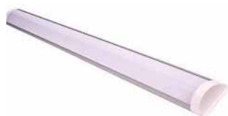
LÁMPARA LED 18W ANTIPOLVO 85-265W 60CM, RA 80, PF 0.65, LUMENES 1140
