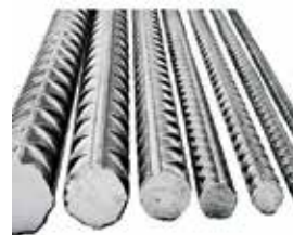
CABILLA ESTRIADA DE 1/2" DIAMETRO 6 MT LARGO, 5,96 KG POR PIEZA
