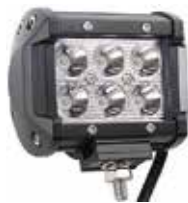
FAROS LED 18W DE 4" TECNOLOGIA CREE 9-36V INCLUYE BASE SOLIDA
