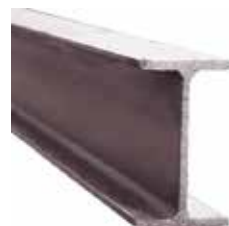
VIGA IPE260 (260X130) ACERO ASTM 1018CS (ALMA 257MMX8MM - ALA 133X10MM) X 12 MTS
