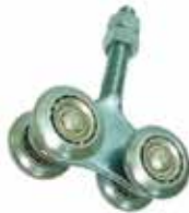
GARRUCHA (GALVANIZADA-ZINCADA) DE PORTÓN R30 DE 4 RUEDAS (1 1/2" CADA RUEDA) PARA RIEL DE 2" (SIN BASE, PESO KG 0,544).
