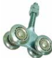
GARRUCHA (GALVANIZADA-ZINCADA) DE PORTÓN R70 DE 4 RUEDAS (2" O 55MM CADA RUEDA) PARA RIEL DE 2 1/2" (SIN BASE, PESO KG 1,408).
