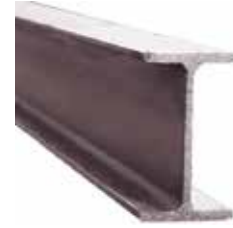
VIGA IPE180 (186X91) ACERO A570 ALMA & A36 ALA (ALMA: 186X5,1MM - ALA 91X8MM) X 12 MTS
