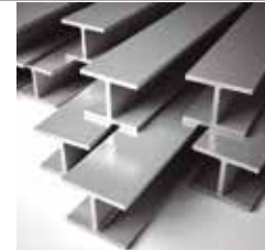
VIGAS H420 (420X400) ACERO A36 (ALMA: 420X10MM - ALA 400X12MM) X 12 MTS
