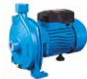
BOMBA DE AGUA CENTRIFUGA DE 1 HP (0,75KW), SUCCION MAXIMA 9MT, CAUDAL MAXIMO 90 LITROS/MIN, ALTURA MÁXIMA 22MT, DIAMETRO SALIDA/ENTRADA 1", TAMAÑO 25X25MM, 3420 RPM, PALETA INTERNA DE BRONCE, ALAMBRE COBRE,
