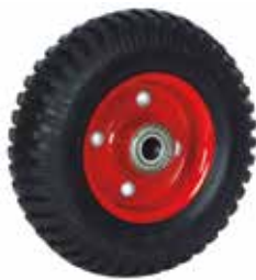
RUEDA DE 10" SOLIDO-MACIZO (GOMA NEGRA) CON DOBLE ROLINERA NO. 6203, HUECO DE 20 MM, RIN DE ACERO PINTADO DE ROJO CON POLVO ACRÍLICO
