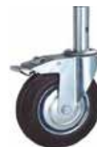
RUEDA CASTER DE 6" PARA ANDAMIOS, GOMA NEGRA, ROLIN- ERA Y FRENOS. DIAMETRO DE LA BARRA REDONDA ES 1-3/8" Y EL LARGO ES 90 MM. TANTO BARRA COMO FRENOS, COMO RIN Y COMO SOPORTE SUPERIOR SON GALVA- NIZADOS.
