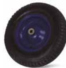
RUEDA DE 14" SOLIDO-MACIZO (PU), PATRÓN CUADRADO, DIÁMETRO DEL HUECO DE 20MM , LARGO DEL HUECO DE 92 MM, RIN DE ACERO PINTADO DE AZUL CON POLVO ACRÍLICO
