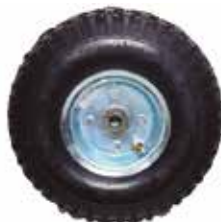
RUEDA NEUMÁTICA DE 8" (2,5-4PR), INCLUYE CÁMARA TRIPA DE AIRE: DIÁMETRO DEL HUECO DE 20MM , LARGO DEL HUECO DE 62 MM (ARMADO CON TORNILOS Y TUERCAS), RIN ACERO GALVANIZADO EN ZINC
