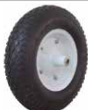
RUEDA NEUMÁTICA DE 16" (4.00-8 ), INCLUYE CÁMARA - TRIPA DE AIRE (4.00-8-2PR): DIÁMETRO DEL HUECO DE 20MM , LARGO DEL HUECO DE 92 MM (ARMADO CON TORNILOS Y TUERCAS), RIN DE ACERO PINTADO DE BLANCO CON POLVO ACRÍLICO
