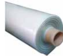
PLÁSTICO TECHO INVERNADERO FABRICADO CON POLIETILENO VIRGEN DE BAJA DENSIDAD (LLDPE), CON 10% DE COMPONENTE ANTI RAYOS UV (3 A 5 AÑOS DE VIDA MEDIA), 200 MICRAS DE ESPESOR, CALIDAD INTERNACIONAL ISO9001, 115 KG, ROLLO 6X100MT, COLOR TRANSPARENTE-LECHOSO (89% TRANSMISIÓN DE LUZ), TRACCIÓN A LA ROTURA DE MÁXIMA 26MPA
