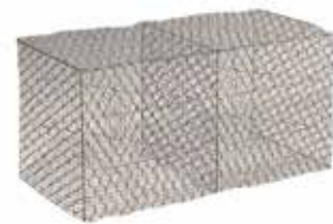
MALLA GAVION HUECO 3X4", ALAMBRE GALVANIZADO GRUESO 2,7 MM (BWG CALIBRE 12), 2 MTR LARGO X 1 MTR ANCHO X 1 MTR ALTO
