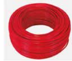
ROLLO CABLE THW 12AWG ROJO 100% COBRE TIPO THW/THHN DE 7 HILOS (0,78MM), PROTECCION PVC, 600V (100 MT)
