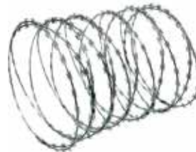
CONCERTINA DE SEGURIDAD MODELO BTO-22, 10MT LARGO POR ROLLO, 7KG EL ROLLO, 55 BUCLE-SERPENTINAS, 450MM DIAMETRO
