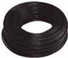
ROLLO CABLE THW 10AWG NEGRO 100% COBRE TIPO THW/THHN DE 7 HILOS (0,99MM), PROTECCION PVC, 600V (100 MT)
