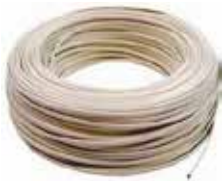
ROLLO CABLE THW 12AWG BLANCO 100% COBRE TIPO THW/THHN DE 7 HILOS (0,78MM), PROTECCION PVC, 600V (100 MT)
