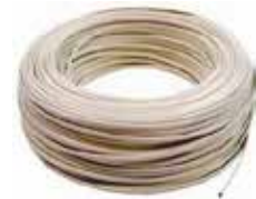
ROLLO CABLE THW 8AWG BLANCO 100% ALUMINIO TIPO THW/THHN DE 7 HILOS (1,23MM), PROTECCION PVC, 600V (100 MT)
