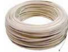
ROLLO CABLE THW 10AWG BLANCO 100% COBRE TIPO THW/THHN DE 7 HILOS (0,99MM), PROTECCION PVC, 600V (100 MT)
