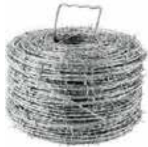
ALAMBRE DE PUA DE 1,55MM (400 MT LARGO - 16 KG ROLLO - PUAS SEPARADAS CADA 5") GALVANIZADO EN PISCINA CALIENTE DE ZINC "HOT DIP"
