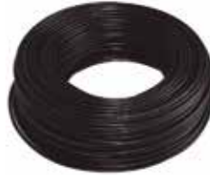
ROLLO CABLE THW 16AWG NEGRO FLEXIBLE 100% COBRE TIPO THW/THHN DE 40 HILOS (0,2MM), PROTECCION PVC DE TEMPERATURA FLEXIBLE, 600V (100 MT)
