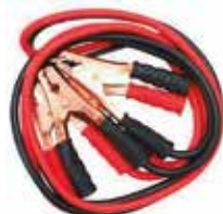
CABLE AUXILIAR BATERIA VEHICULO CCA 500 AMP 2,5M 14AWG CCA (DIAMETRO POR ALAMBRE 0,3MM, 114 ALAMBRES, DIAM.EXTERNO: 7,5MM, LONGITUD: 2,5M, PINZA NO. C-26 (INCLUYE BOLSA PLASTICO CON CIERRE "CREMALLERA")
