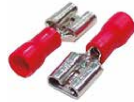
TERMINAL HEMBRA AISLANTE ROJO 16-22 AWG (CABLE DE 0,5MM A 1,5MM2)
